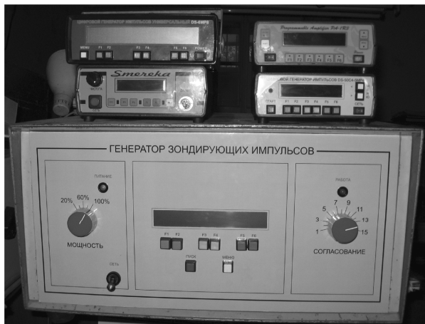
Рис. 2. Генераторы зондирующих импульсов для питания ЭМАП пакетными импульсами в диапазоне частот 0,1...23 МГц и формирующие пиковые токи 20...200 А
