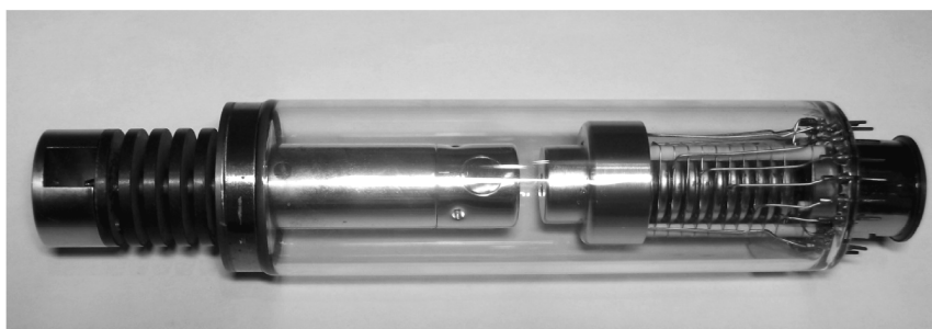
Рис. 1. Внешний вид рентгеновской трубки с фотокатодом на напряжение 100 кВ
