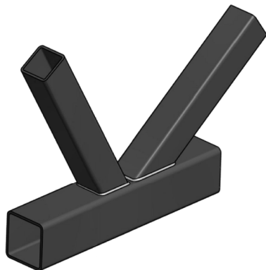
Рис. 1. Схематичное изображение узла сварной металлоконструкции
