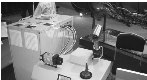
Рис. 1. Автоматизированная установка для инфракрасной диагностики охлаждаемых лопаток турбин (АСТКЛ)
