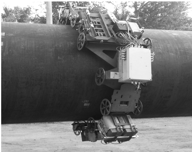
Рис. 1. Вихревой контроль с применением сканера-дефектоскопа АСД «Вихрь-1» в летних (а) и в зимних (б) условиях
