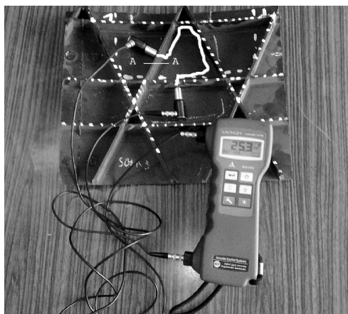
Рис. 3. Способ двугранного угла применительно к сетчатым структурам. Белая линия – предположительно путь «обхода» УЗ-колебаний при нарушении сплошности по сечению А-А
