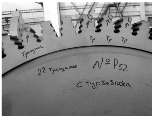
Рис. 1. Диск с трещинами в елочных пазах
