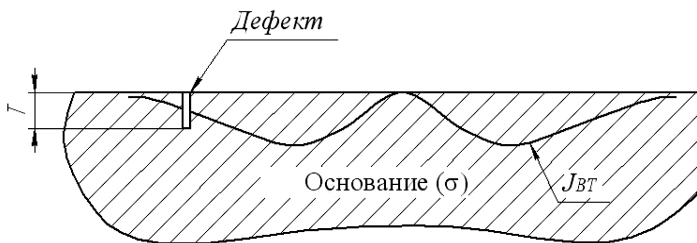
Рис. 3. Распространение вихревых токов в электропроводящем неферромагнитном изделии
