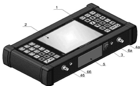
Рис. 1. Общий вид прибора: 1 – клавиатура; 2 – дисплей; 3 – кнопка «ВКЛ/ВЫКЛ»; 4а,б – разъемы каналов; 5 – заглушка отсека интерфейсных разъемов; 6а,б – разъемы цифровых каналов
