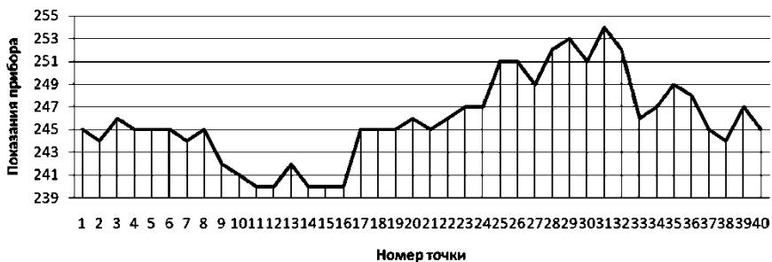
Рис. 2. Показания прибора при одинаковой толщине измеряемого слоя
